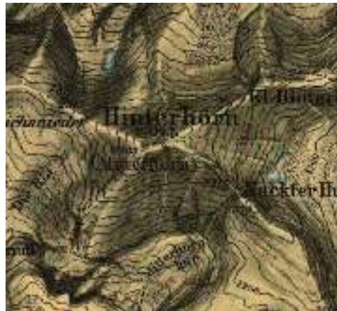
Figure 23: Grey rock area. The steeper the rock the darker the colour. Source: Alpenvereinskarte Loferer Steinberge, wissenschaftliche Ausgabe [Finsterwalder, 1925].
